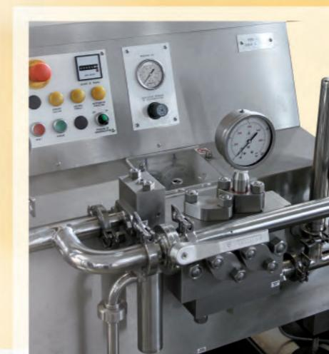
Dettaglio della testata di omogeneizzazione
