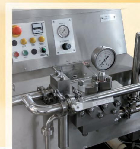
Dettaglio della testata di omogeneizzazione
