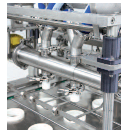
Stazione di dosaggio/Doser unit
