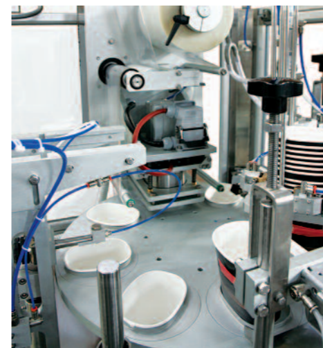
Stazione di dosaggio / Doser unit
